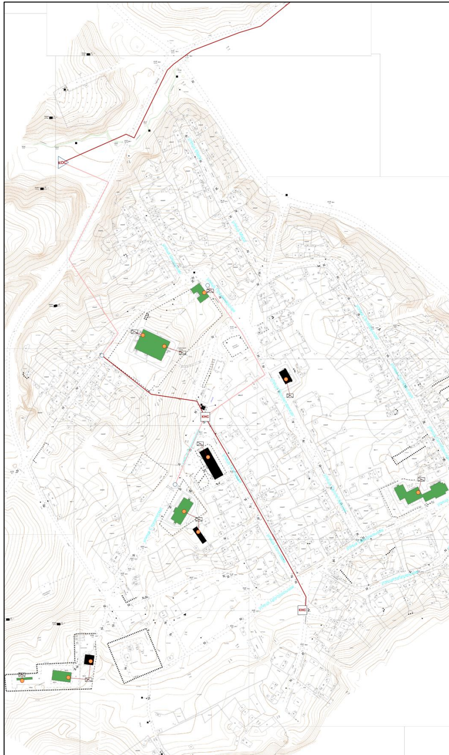
Рис.4.2. Границы планируемых зон размещения объектов централизованной и децентрализованной систем водоотведения сельского поселения Зайцева Речка
